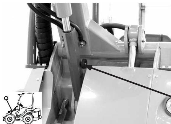
Sikre løftesyylinderstøtten med bolten når støtten er montert på forrammen.
