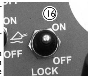
LOCK ON: Ventilen er stengt – oljestrømmen fra venstre til høyre side og omvendt er blokkert. Maskinens trekkeveie øker på ujevnt og glatt underlag: hjulene som står på bakken driver selv om hjulet på den andre siden er i luften. Dersom maskinen ikke har fordelerventil, kan ikke olje flyte fritt mellom høyre og venstre side.
