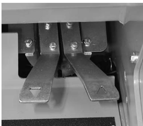
Maskinen er utstyrt med en stempelpumpe for kjøringen – fremdriften er hydrostatisk. Husk at kjørepedalene ikke fungerer som gasspedaler – de er snarere pedaler for å endre girtrinn: **Når du vil ha størst mulig trekkraft, brukes høyt motorturtall mens det kun trykkes lett på kjørepedalen.** Når kjørepedalen trykkes helt ned, øker kjørehastigheten mens trekkraften reduseres.
